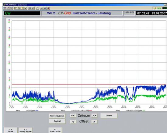
Durch Erzeugungsmanagement des Stromversorgers werden mit herkömmlichen Steuerungssystemen bislang alle Anlagen in ihrer Leistung reduziert. Maßgeblich ist aber die Leistung am Netzverknüpfungspunkt. **EP-Grid** gleicht die verfügbaren Leistungen einer Anlage mit den tatsächlichen ab und optimiert so Ihre *Rendite*.
