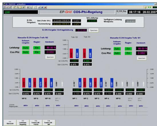
Durch Mittelspannungskabel und Transformatoren wird der Leistungsfaktor und somit die verrechenbare Wirkarbeit am Netzverknüpfungspunkt beeinflusst. Optimiert man den Leistungsfaktor, steigt die *Rendite*.
